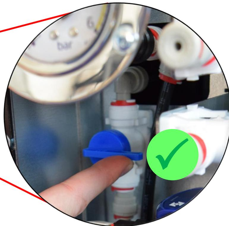
Chiudere la valvola del bypass automatico.
