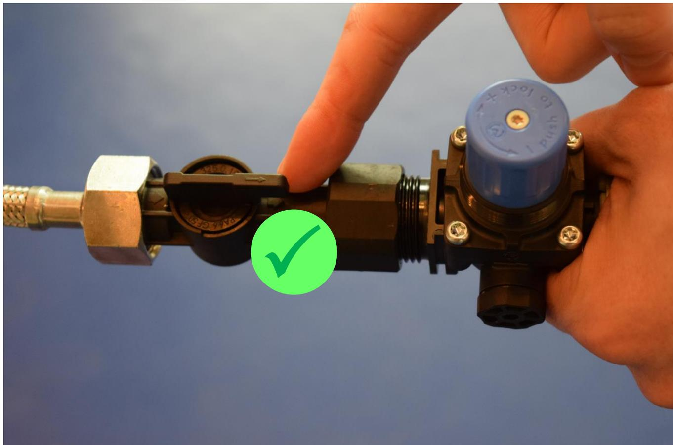
Chiudi la maniglia di bloccaggio della testa del filtro.
