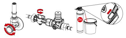
Collegando la testata di lavaggio in dotazione alla cartuccia a membrana PURITY C150 PROGUARD durante il lavaggio della cartuccia di mineralizzazione nella testata del pre-filtro (fase 3.2):
